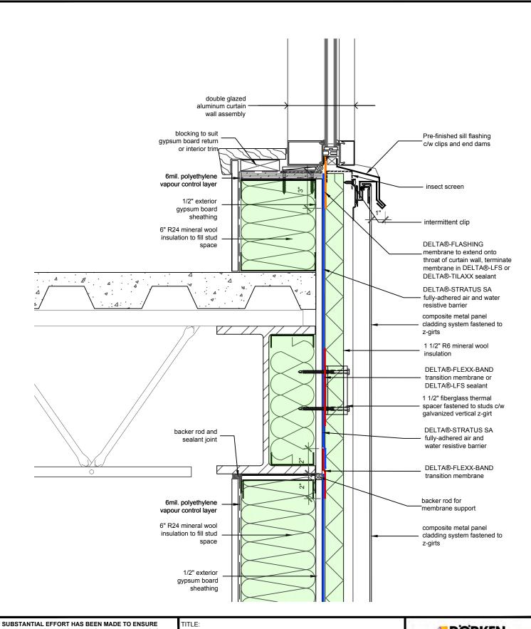
WALL ASSEMBLY #1: TYPICAL CURTAIN WALL SILL
