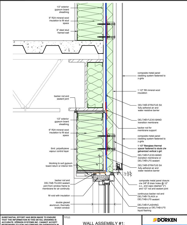
WALL ASSEMBLY #1: TYPICAL PUNCHED WINDOW HEAD
